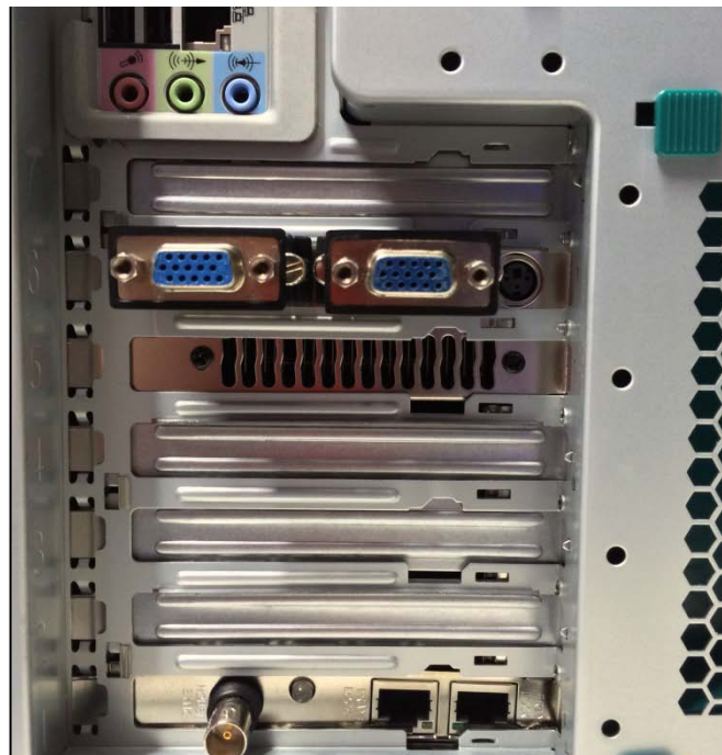
Bild 10: Anschlüsse eines Rendering Slaves des zuvor genutzten Grafikkclusters
