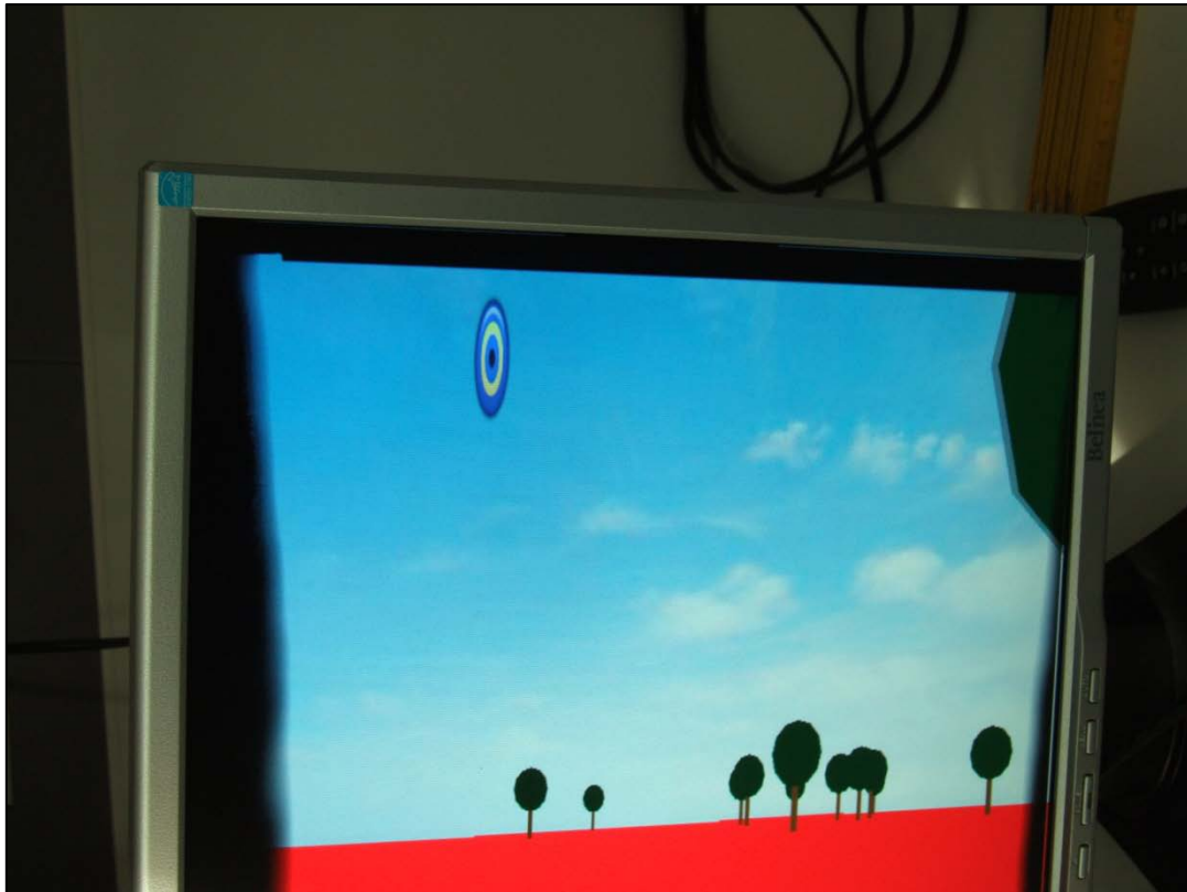
Bild 8: Darstellung mit Verzerrungskorrektur Überblendung/Maskierung
