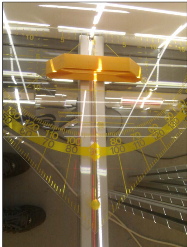
Bild 23-26: Zentrieren der Beamer und Ausrichten der Projektor-Brücke im rechten Winkel zur Projektionsoberfläche
