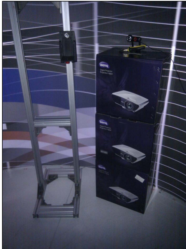
Bild 32: Kameraposition zur Kalibrierung der Beamer-Brücke #1
