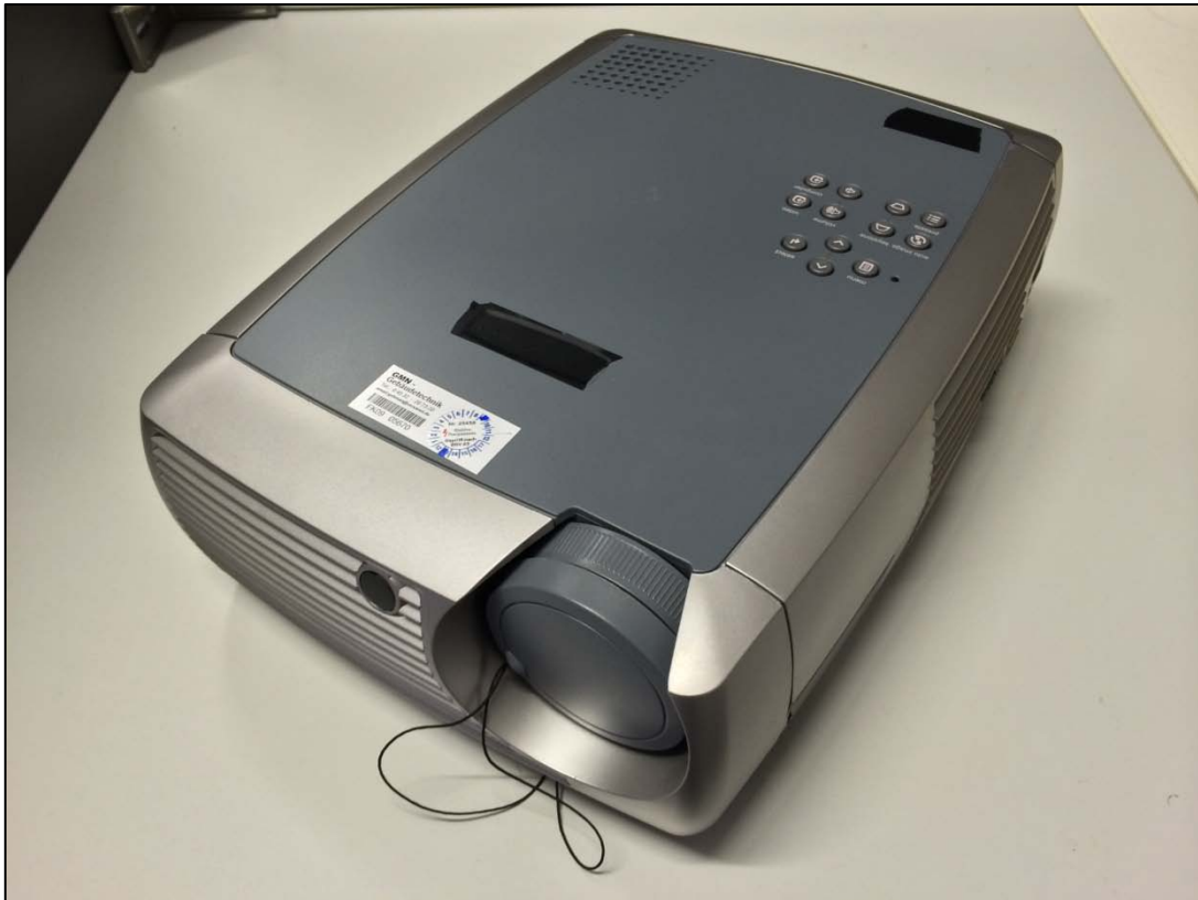
Bild 11: InFocus DepthQ, shutterfähiger 120Hz Projektor
