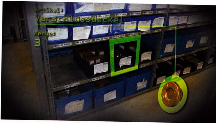
Blick durch die Datenbrille: Die Anzeige verrät, aus welchem Fach wie viele Teile zu nehmen sind
